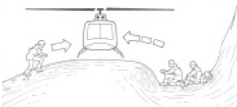
C15-15 Avvicinamento su pendio
