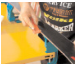
C2-14 Eliminazione della sciolina dalle lamine
