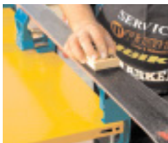
C2-16 Asportazione della sciolina con spazzola
