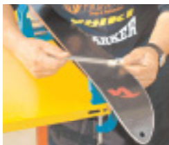
C2-04 Lima fine per abbassamento lamine
