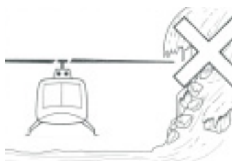
C15-07 Zone di atterraggio -d non trovarsi sotto la minaccia di sassi o valanghe
