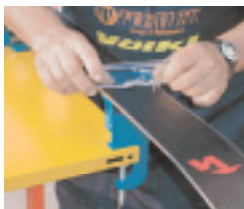
C2-15 Asportazione della sciolina con spatola
